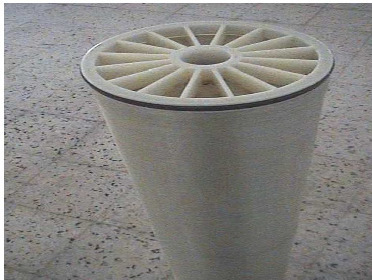
Figures III.3 : La face externe d'un module d'osmose inverse utilisée au niveau de Cevital.
