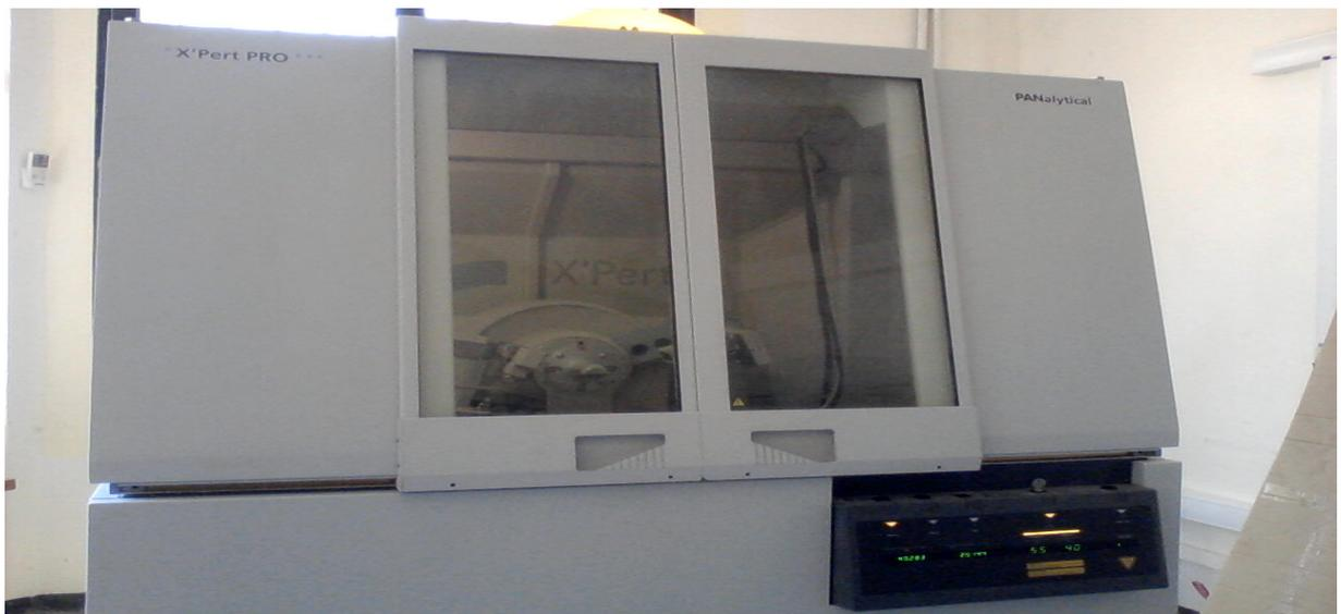
**Figure II.8 :** Diffraction des Rayons X (DRX)
