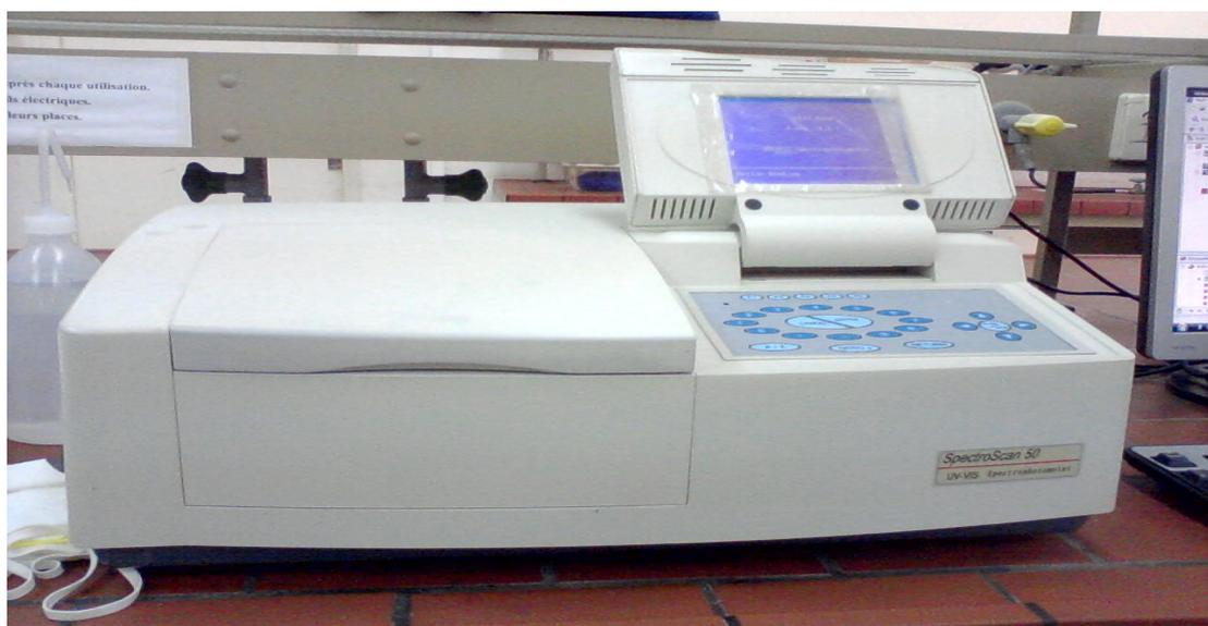
**Figure II.9** : Spectrophotomètre Ultraviolet-Visible (UV-Visible)
