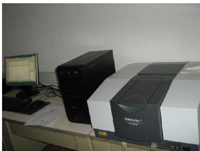
Figure III.6: appareil infrarouge utilisée.
