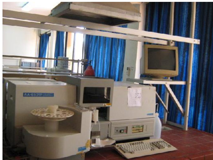
Figure IV.1: Appareil Spectrophotométrie d'absorption atomique (SAA) utilisée.
