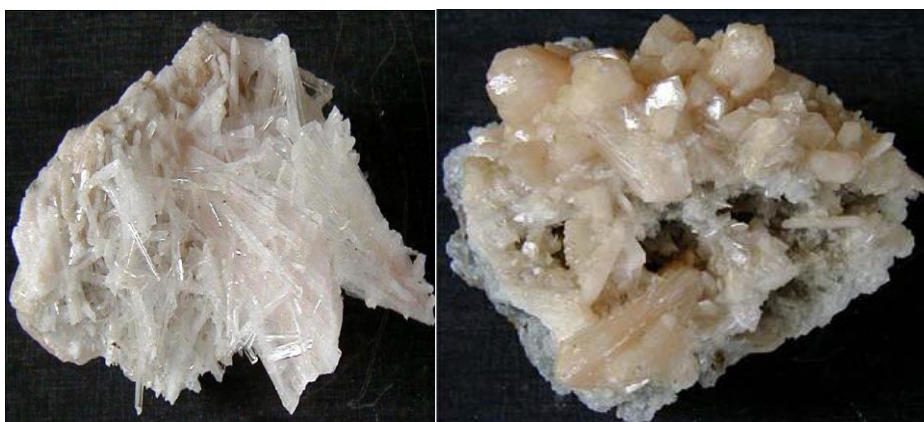
Figure I.3: Deux zéolithes naturelles: la Scolecite (à droite) et la Stilbite (à gauche) [31].
