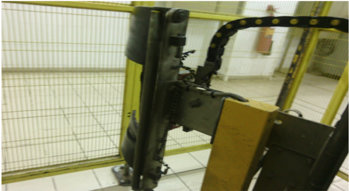
FIG.III.7. Coupe film à chaud et soudeuse film.
