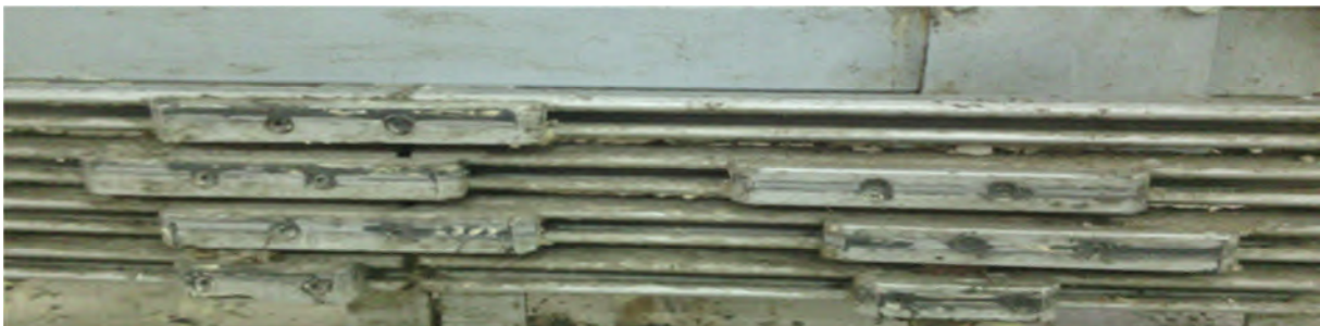
Figure.III.3. barres de fin de course d'adressage d'une entrée et une sortie d'une palette par la navette
