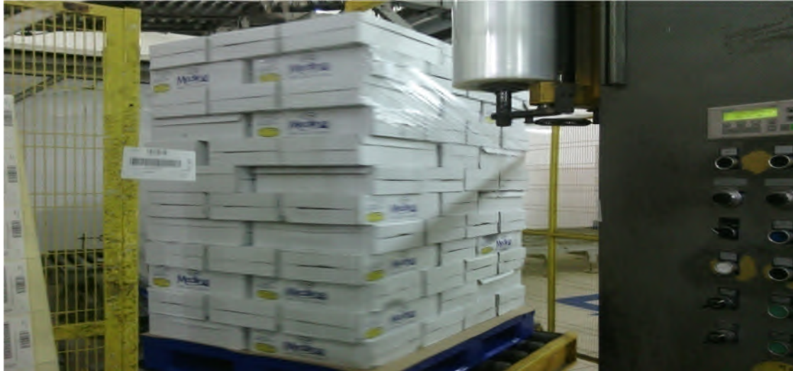
Figure I.4. Banderoleuse a bras tournant
