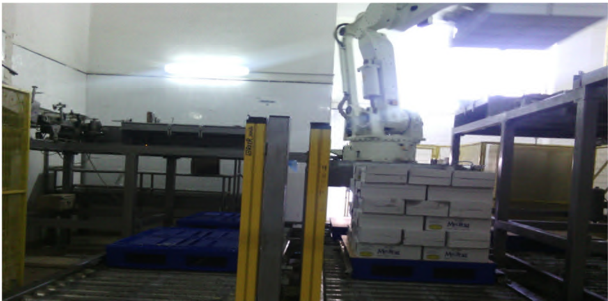
Figure.III.2. Palettisation de deux lignes de sortie assurées par un bras de robot
