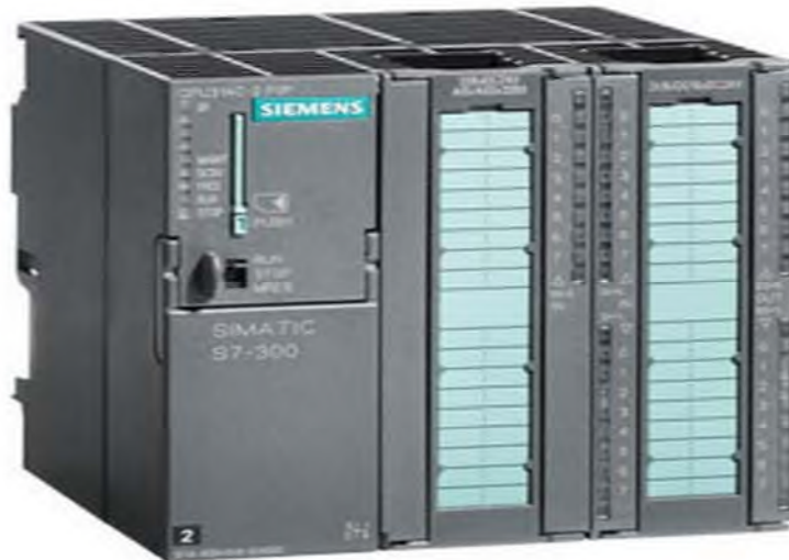
Figure II.3. SIMATIC S7-300 de Type modulaire.
