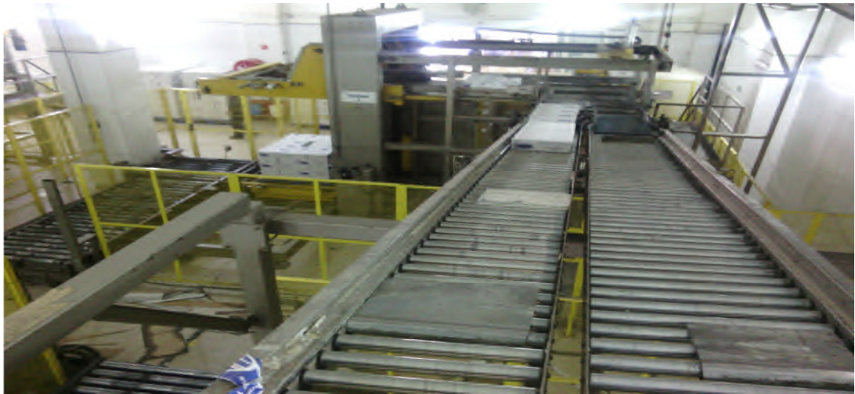
Figure I.2. Palettiseur gérant deux lignes de production
