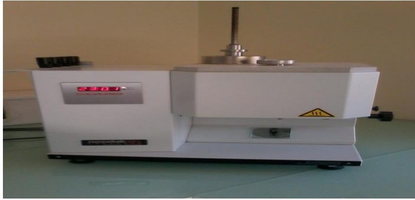
Figure III. 8. Photographie d'un fluidimètre
