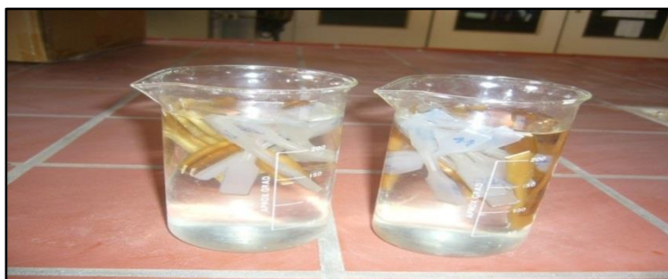
Figure III. 6. Photographie d'échantillons soumis au test d'absorption d'eau.
