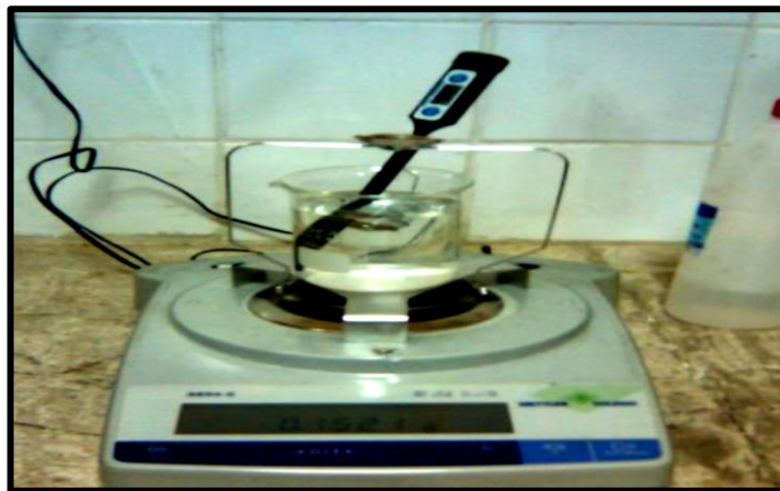
Figure III. 7. Photographie de l'appareillage du test de densité.
