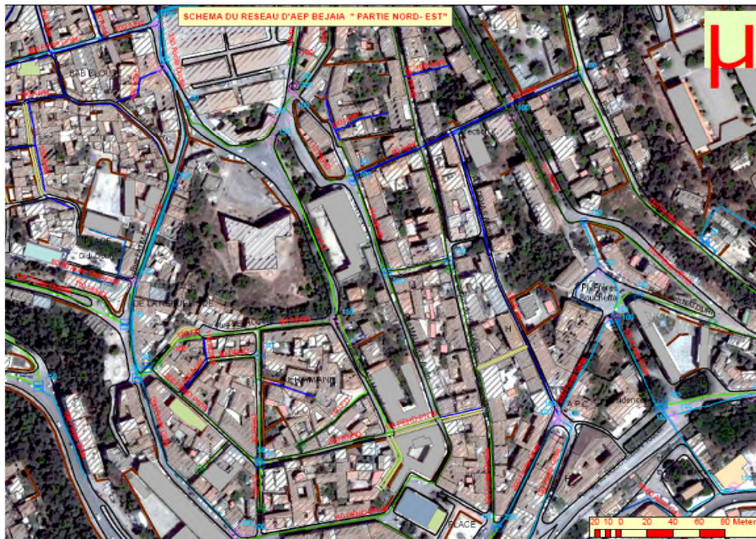
Figure V.6 : Schéma du réseau d'AEP de la partie nord-est de la ville représentant la nature des conduites (source ADE).
