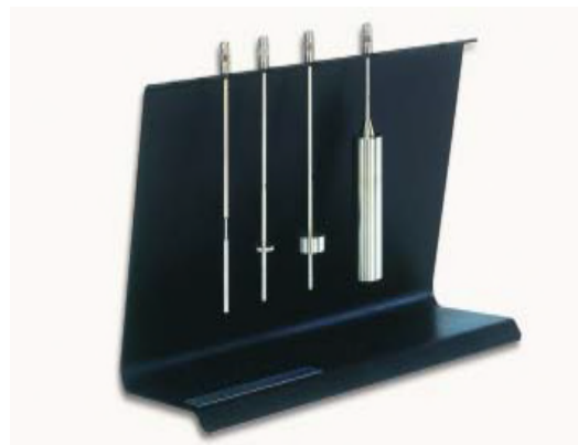
Figure IV.3 : Les différents mobiles d'un viscosimètre Brookfield SNB-1.
