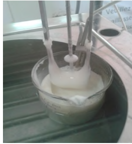
Figure IV.6 : L'installation pour la vérification de la viscosité en fonction de la température.
