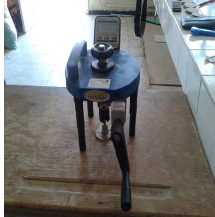
Figure IV.11 : L'appareil d'essai d'adhérence.
