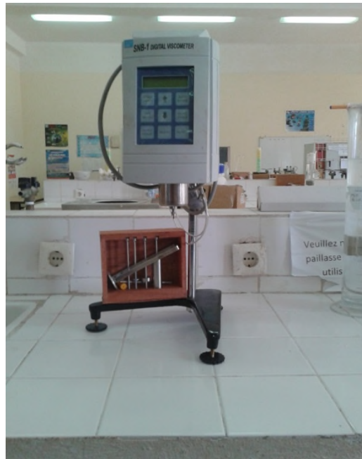
Figure IV.2 : Le viscosimètre de Brookfield SNB-1
