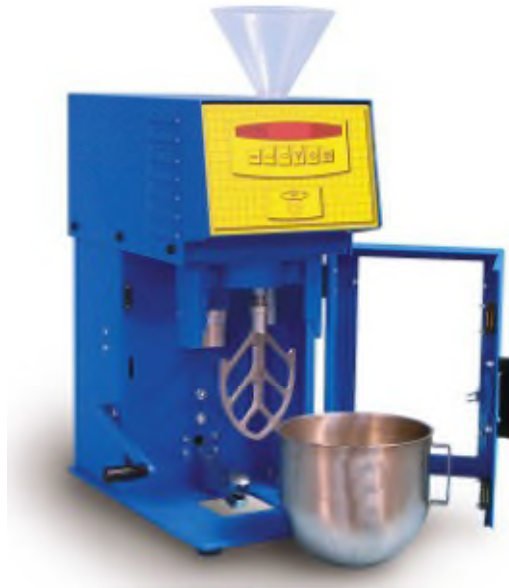
Figure IV.1 : Malaxeur automatique de mortier 096 [65].
