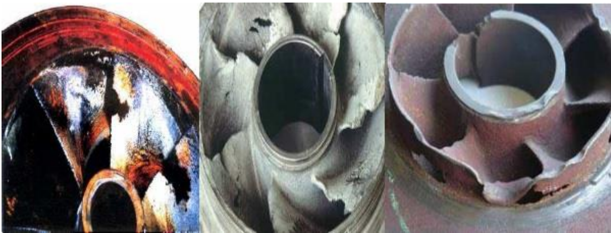
Figure (VI.18) : Phénomène de cavitation sur les aubes d'une pompe centrifuge
