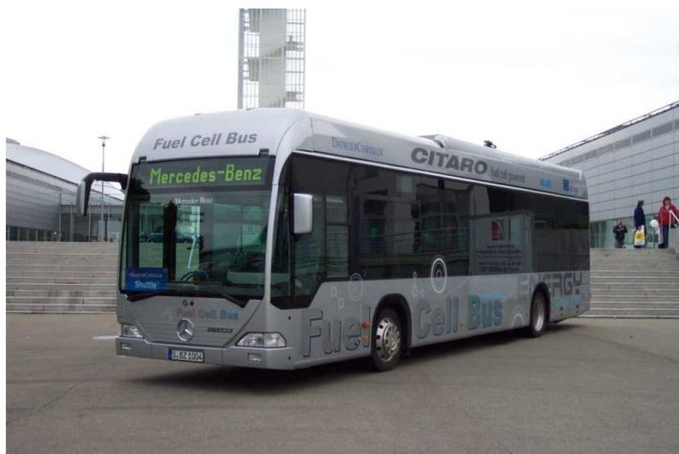
Figure Erreur ! Il n'y a pas de texte répondant à ce style dans ce document..4 Bus Mercedes Citaro fonctionnant avec une PEMFC
