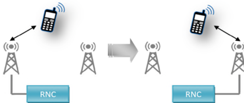
Figure 1.22 : Exemple de hard handover.
