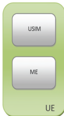
Figure 1.9 : Architecture de l'équipement utilisateur.
