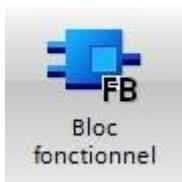
Ce sont des blocs de code qui mémorisent durablement leurs paramètres d'entrée, de sortie et d'entrée/sortie dans des blocs de données d'instance afin qu'il soit possible d'y accéder même après le traitement de blocs.
