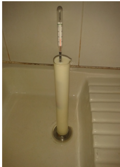
Figure 03: Mesure de la masse volumique par lactodensimètre
