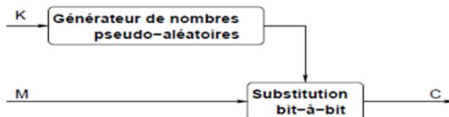
FIGURE 2.3 – Chiffrement symétrique par flot
