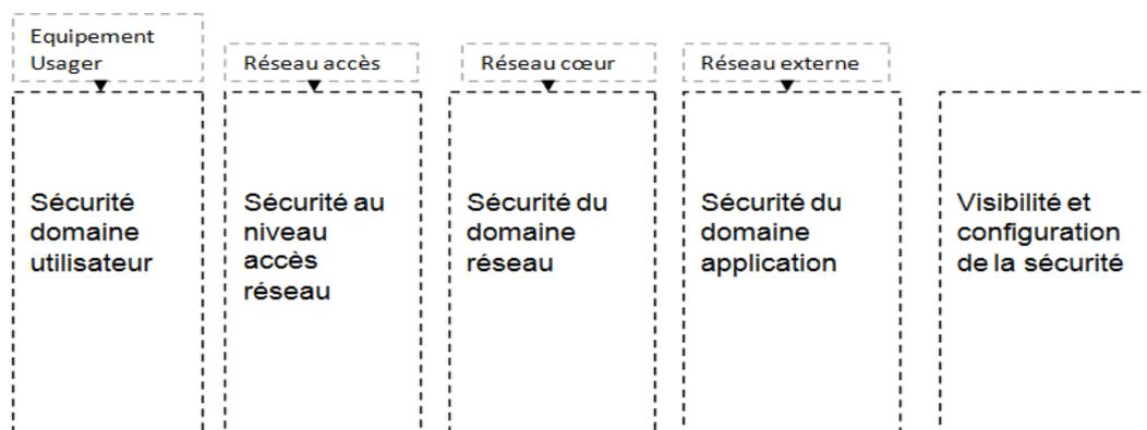
FIGURE 2.12 – Architecture de sécurité du réseau UMTS
