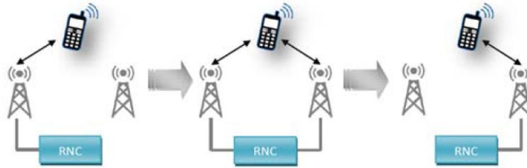
FIGURE 1.9 – Le soft handover dans le réseau UMTS
