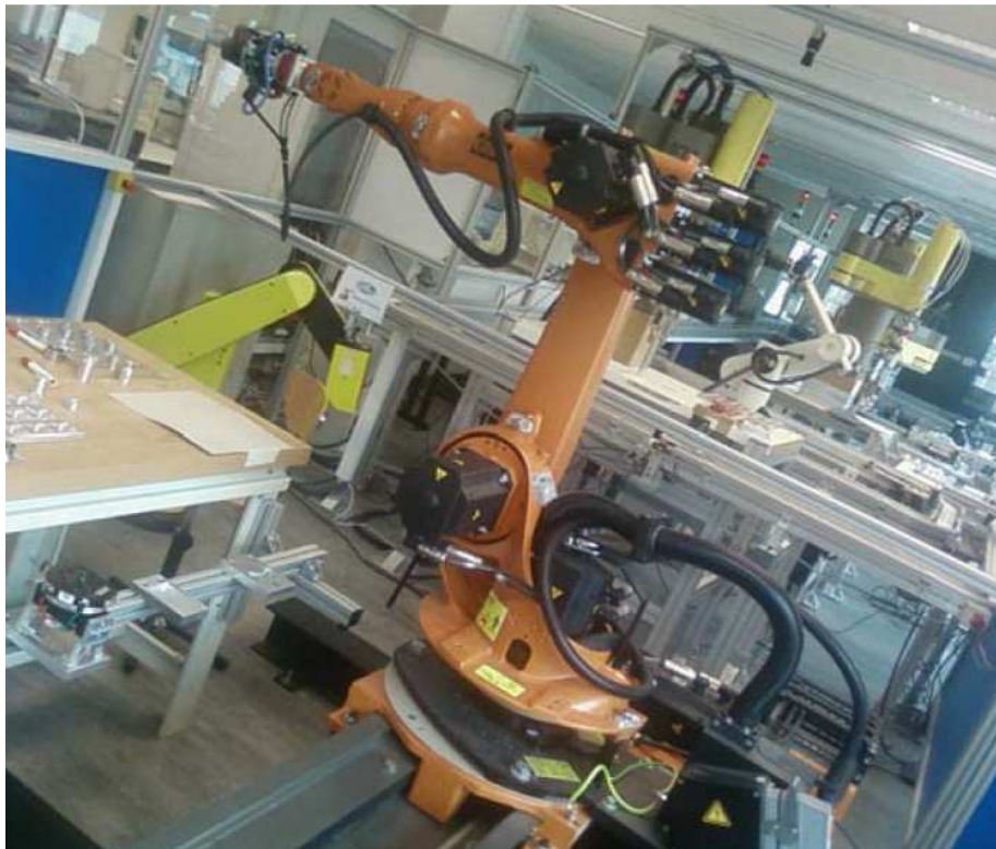
Figure II.3 Exemple d'un bras manipulateur (KUKA KR6 ARC) à 7ddl.
