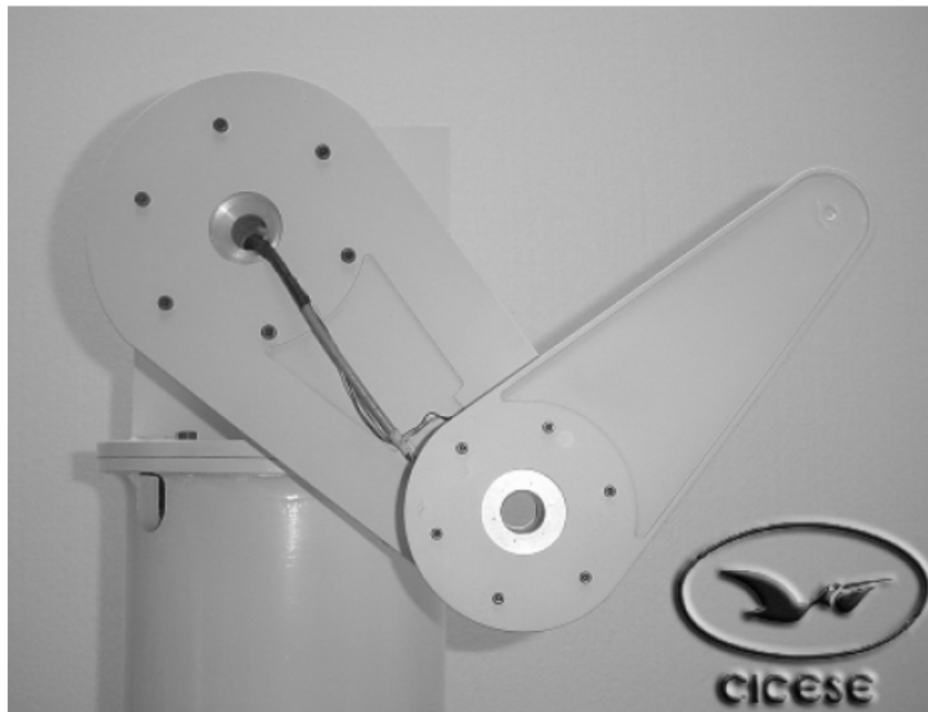
Figure IV.1 Pelican : bras de robot expérimental de CICESE, laboratoire de robotique
