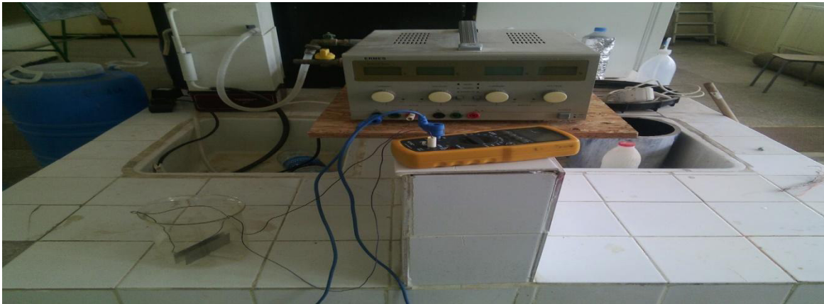
Figure (IV.2) : Réacteur électrochimique.
