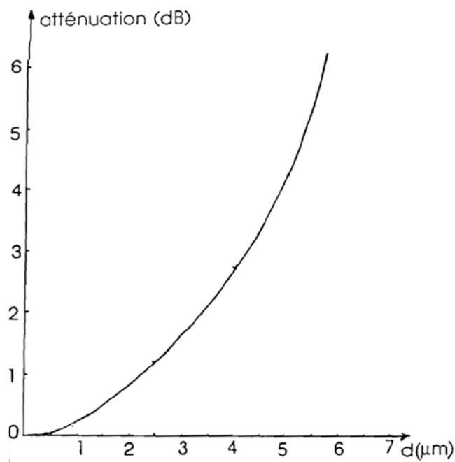
Figure II.18 : pertes de décalage axial relatif à D.
