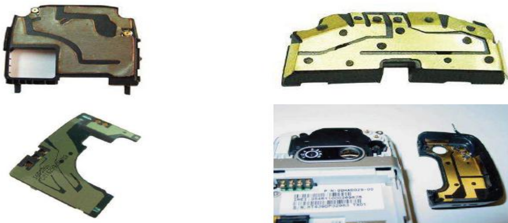
FIGURE 2. 8: Exemples d'antennes PIFA présentes dans des téléphones portables
