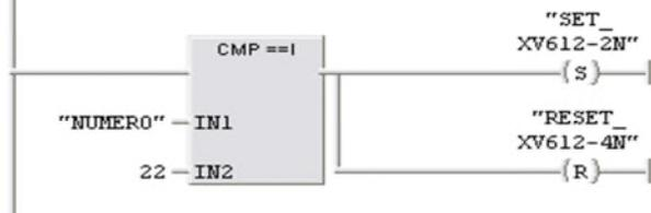
**Réseau 24 : fermeture vanne d'entrée d'eau XV612-2N**
