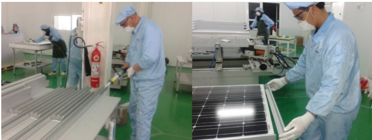
Figure II.25 : préparation du silicone et placement du cadre
