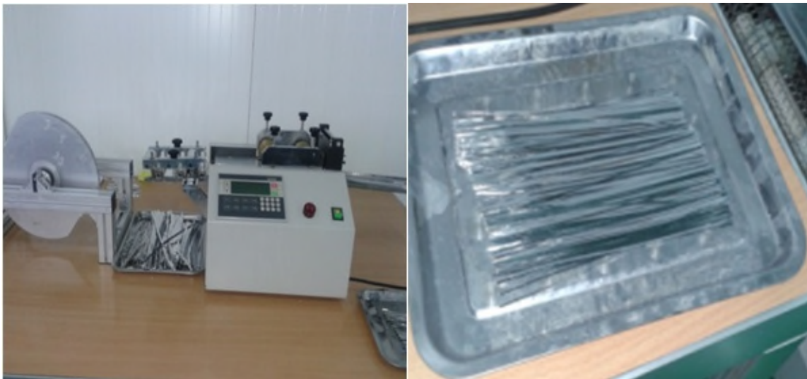
Figure II.13 : Découpage des rubans de soudure
