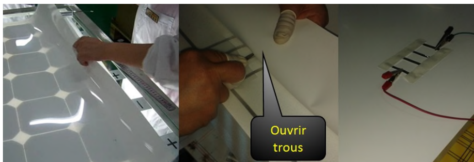
Figure II.20 : placement du back-sheet test de continuité
