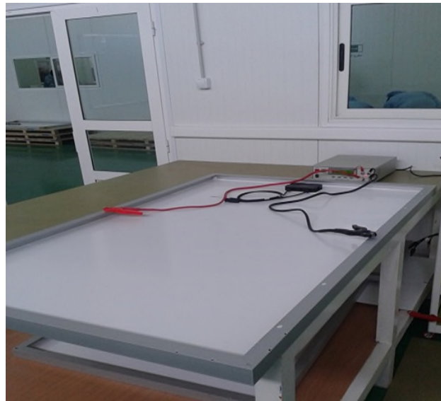
Figure IV.6 : Test de continuité à la masse.
