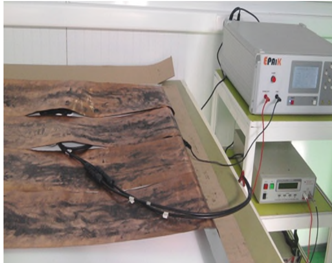
Figure IV.7 : Test de tension d'impulsion.
