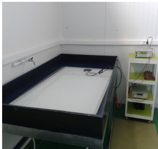
Figure IV.5 : Test de courant de fuite en milieu humide.
