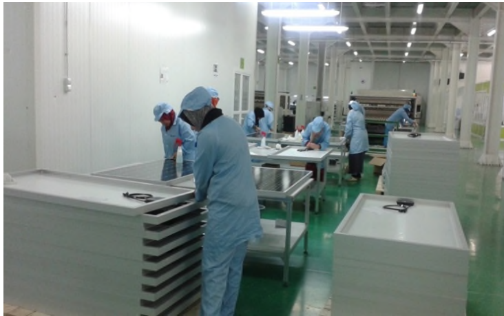
Figure II.27 : Nettoyage du module
