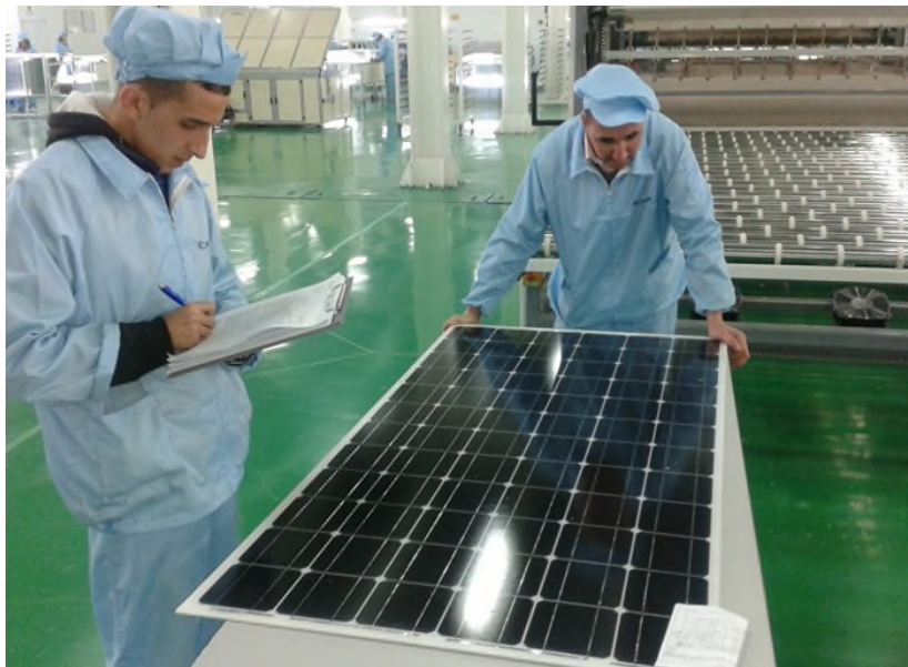
Figure II.24 : Inspection visuel après lamination
