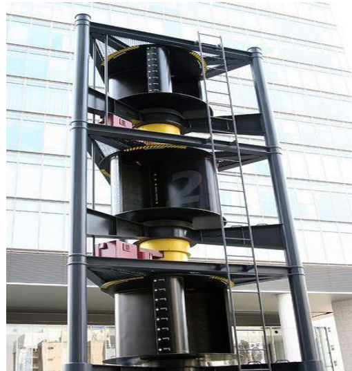
Figure I.5 - Photographie d'une éolienne Savanious [4]
