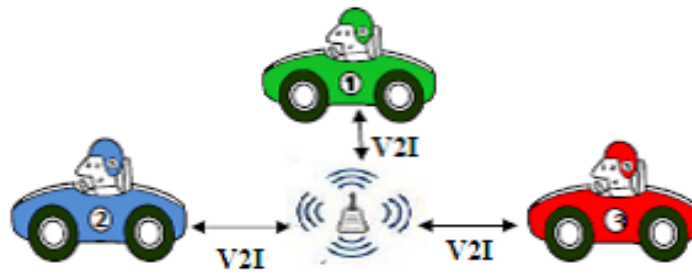
FIGURE 1.8 – Communication Véhicule à Infrastructure
