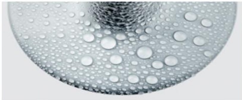
Fig. 2. 9 : hydrophobicité d'une silicone
