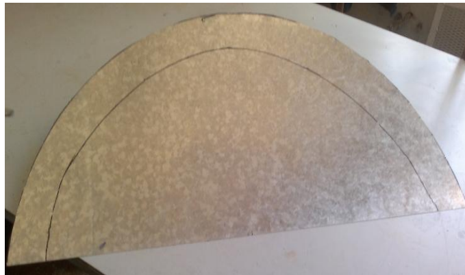
Figure IV.4 : Tôle de fermeture
