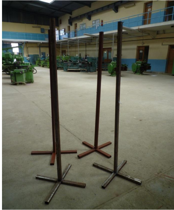
Figure IV.9 : Supports pour la barrière de sécurité
