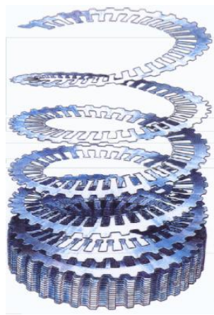
Figure V.6 : Processus slinky, construction du stator en hélice
