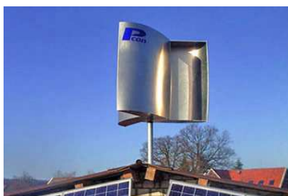
Figure I.6 - Eolienne Savonius sur une toiture [Vri 83].
