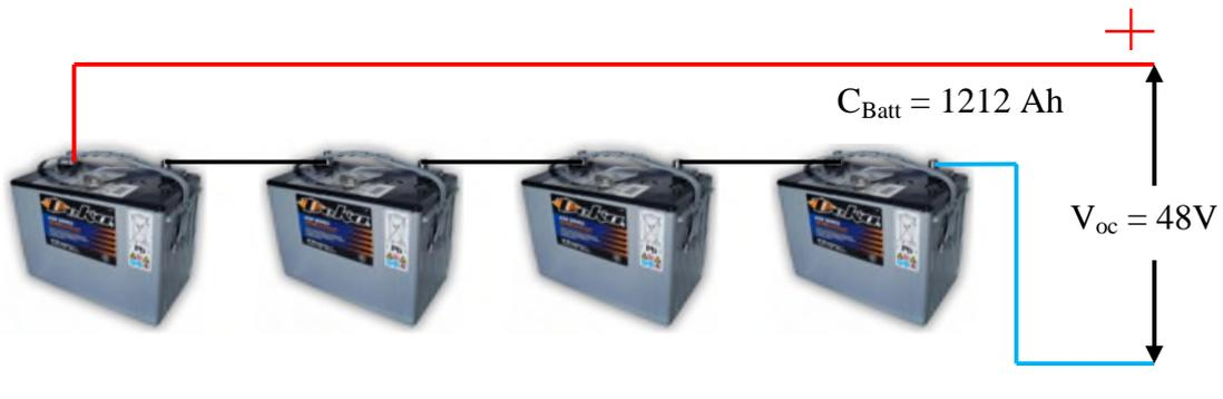
Figure (II.11) : Schéma de montage de champ de batteries Acide-Plomb
