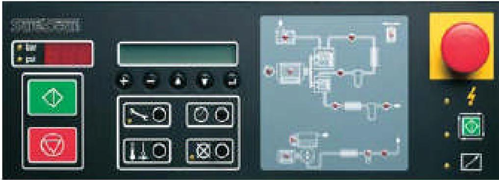
**Figure I.13.** Tableau de commande
