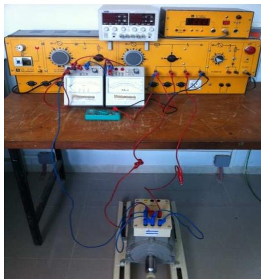
**Fig I.11.** Maquette de l'essai à vide
