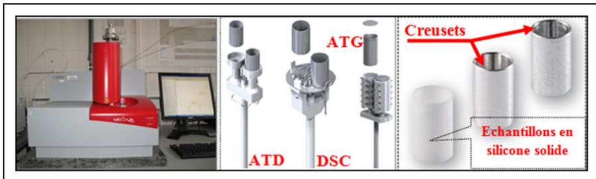
FIG. 2.13 – Appareil DW5470H-3 STA et ses éléments.
