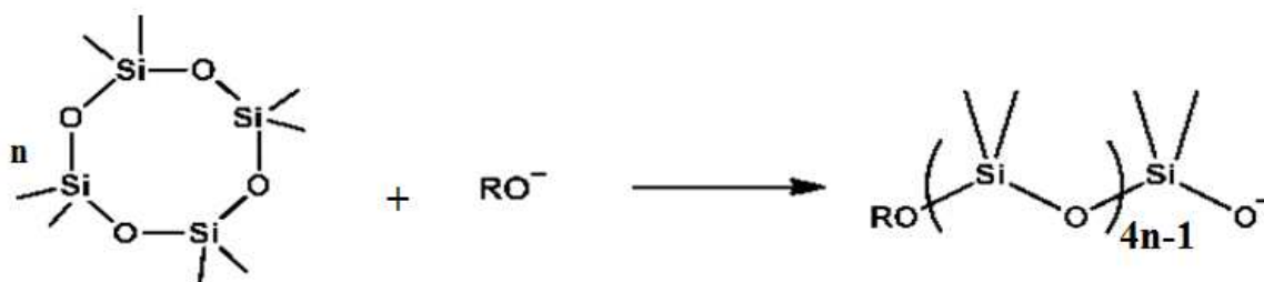
FIG. 1.9 – Ouverture de cycle du D4 par un amorceur anionique.
