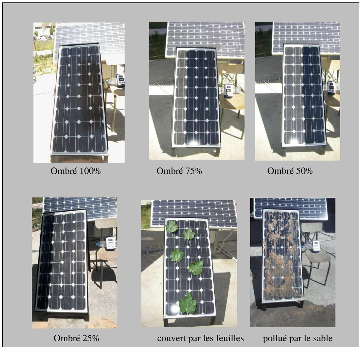
**Fig.IV.4 :** quelque exemple de défauts de mismatch et d'ombrage.
