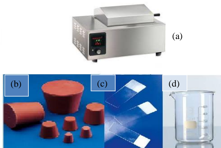
Fig. II.1 : Dispositif expérimental de la technique CBD, (a) Bain marie, (b) Bouchons en Caoutchouc, (c) des lames de verre et (d) Un bécher.
