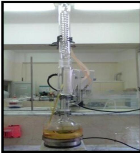
**Figure II.1** : le montage de soxhlet
