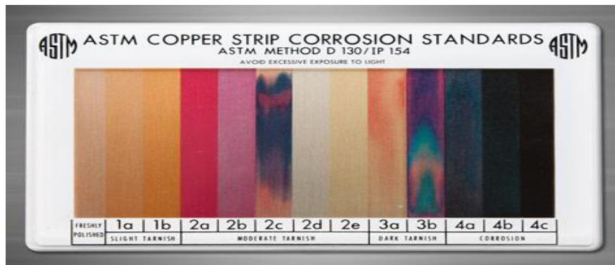
Figure III-14 : La série des lames de référence de la corrosion [24]
