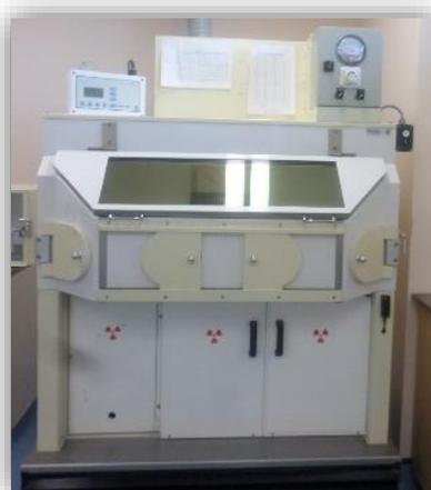
**Figure n° 1 :** la hotte plombée de laboratoire chaud.
