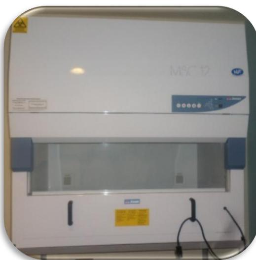
**Figure n° 2 :** la hotte à flux d'air laminaire vertical.
