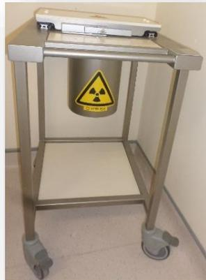
**Figure n° 4 :** Puits de transport des produits radioactifs.
