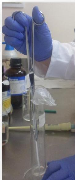
**Figure n°50 :** Dépôt de la plaque dans la burette.
