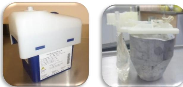
**Figure n°39 :** générateur Cis-bio de  $^{99}\text{Mo}/^{99m}\text{Tc}$
