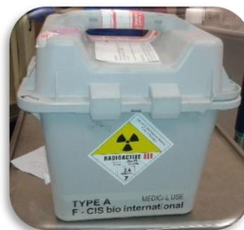
Figure n°20 : le générateur <sup>99</sup>Mo/<sup>99m</sup>Tc en arrivée au service dans son protection plombée.
