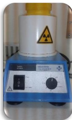
**Figure n°41 :** Agitateur des flacons plombé.
