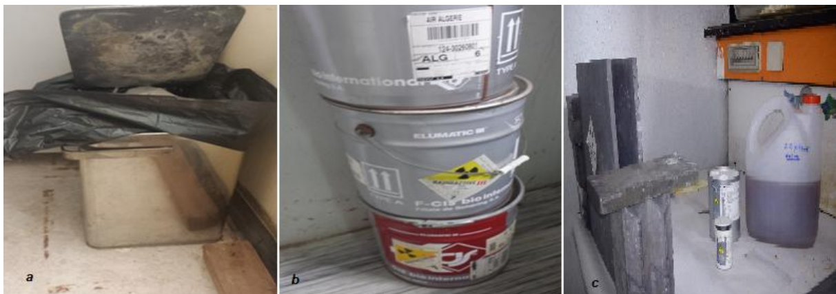
Fig.50. a-Poubelle plombée, b- Fut de stockage, et c- Jerrican pour l'entreposage des déchets.
