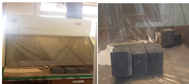
Fig.25. Hotte à flux laminaire avec trois châteaux de plomb.
