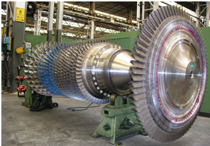
Figure (III-6): Rotor du compresseur de la turbine à gaz MS5002C
