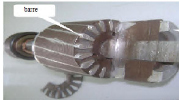
**Fig - I.7** - Rotor à cage d'écureuil
