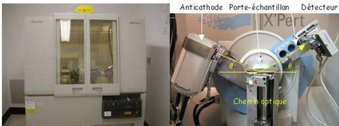
Figure III.1 : Le diffractomètre X'pert Pro Panalytical avec une géométrie Bragg-Brentano.
