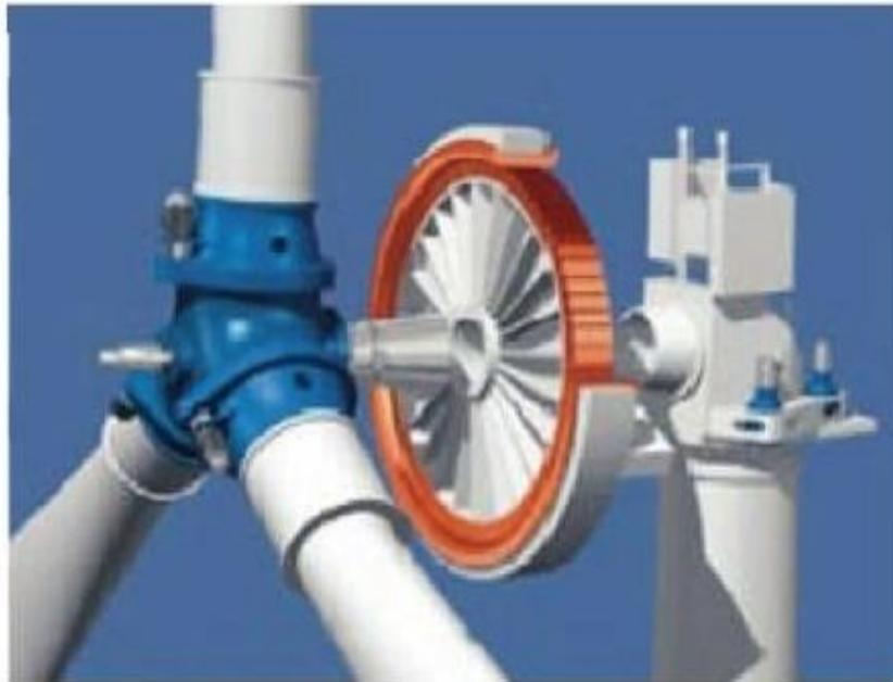
**Figure I-14 : Éolienne à attaque directe**
