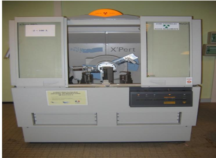
*Figure II-8 : photo de l'appareillage pour la DRX*
