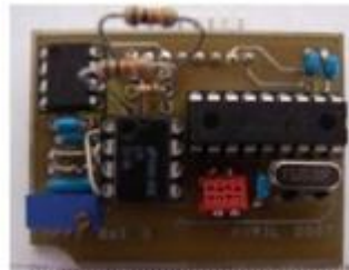
Figure 4.4: Chaîne élémentaire de conversion photovoltaïque avec convertisseur BOOST contrôlé par une commande MPPT numérique.
