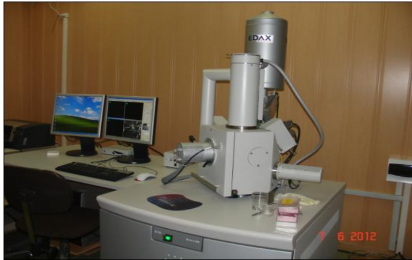
Figure 18 : Microscope électronique à balayage MEB de la marque FEI Quanta 200.
