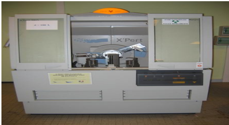
Figure 16: Le diffractomètre Xpert pro paralytical avec une géométrie Bragg-Brnetano.
