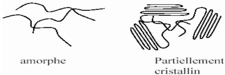
**Figure II.2.6. Structures des polymères thermoplastiques**
