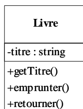
Figure 23 : Exemple de notation UML d'une classe « livre »
