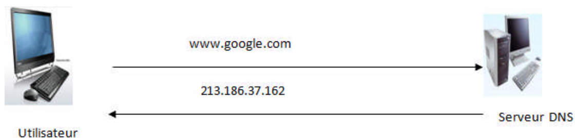
figure15 : résolution d'adresse avec DNS
