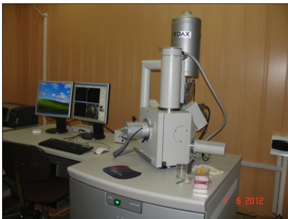
Figure 2 : Microscope électronique à balayage MEB de type FEI Quanta 200.
