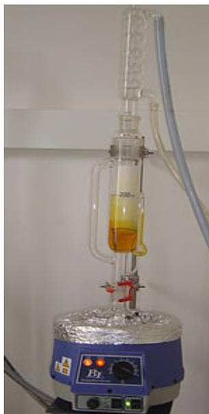
**Figure.19:**L'appareil de Soxhlet.
