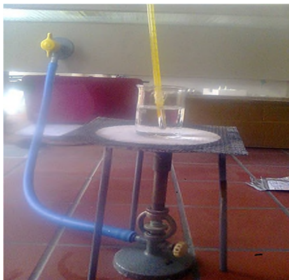
Figure II.2 : Dispositif utilisé pour déterminer la température de fusion
