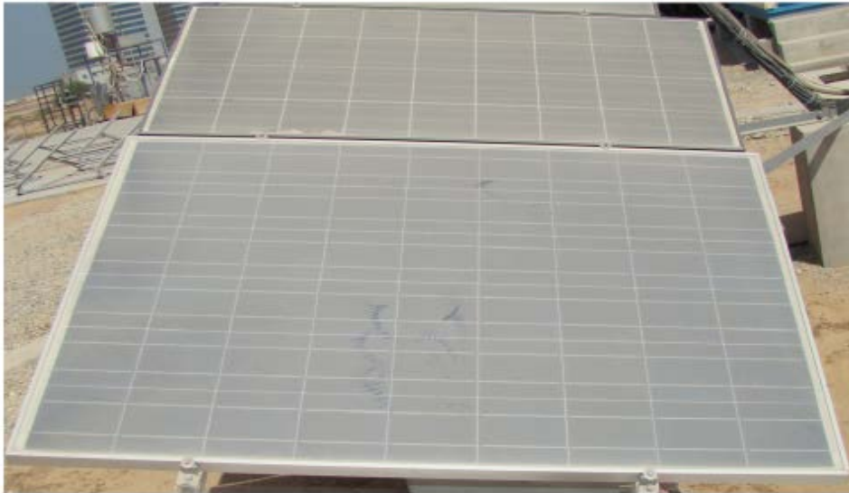
Fig. II.13 : Accumulation de particule de sable sur un module
