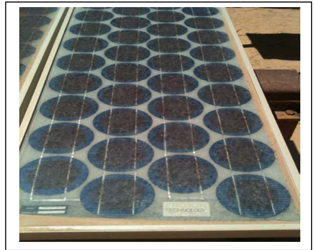
Fig. III.10 : Corrosion des cellules
