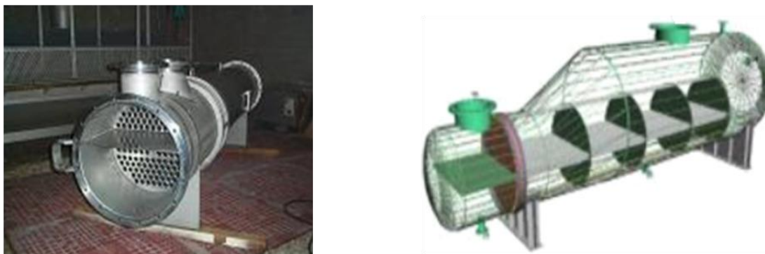
Figure A.5 : Vue intérieure de l'évapocondenseur
