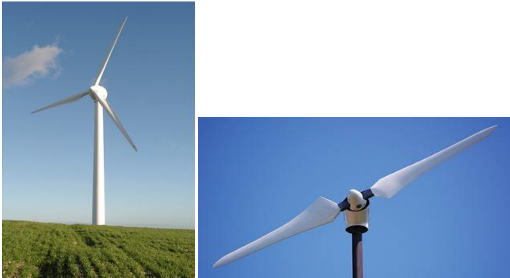
Figure 2.7 Eoliennes à axe horizontal à trois pales (à gauche) et à deux pales (à droite).
